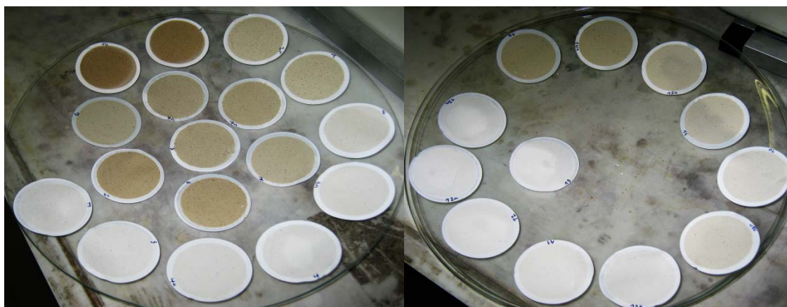
Abbildung 46: Proben im Ablauf der Säule TF IIa nach der Druckfiltration, links: Runde 1 und rechts: Runde 2
